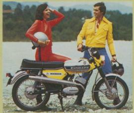
KS 50 Cross: Kleinkraftrad. Die Maschine ist sportlich getrimmt. 6,25 PS, Super-Therm-Zylinder. Elektronische Zündanlage. Komfort-Federung, hochgezogener Auspuff. (Ausführliche Beschreibung – Motorrad-Prospekt.) Führerschein Klasse 4, ab 16 Jahren. Außerdem Klasse 1, 2 oder 3.
