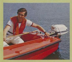
Bootsmotor: Ein in Leistung, Bedienung und Finish optimal ausgelegter 6-PS-Bootsmotor, 85 ccm, Reversier-Handstarter, Leerlauf, Vor- und Rückwärtsgang. Wasserkühlung. Gewicht ca. 19,5 kg. Verbrauch 2,5 Liter pro Stunde. (Ausführliche Beschreibung – Bootsmotoren-Prospekt.)
