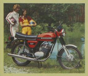
KS 125 Sport: Top-Star von ZÜNDAPP. 17 PS, 125-ccm-Motor. Schrägverrippter Breitwand-Zylinder. Elektronische Zündanlage, sportlich erprobter Doppelschleifrahmen, 5-Gang-Getriebe. (Ausführliche Beschreibung – Motorrad-Prospekt.) Führerschein Klasse 1. ab 18 Jahren.
